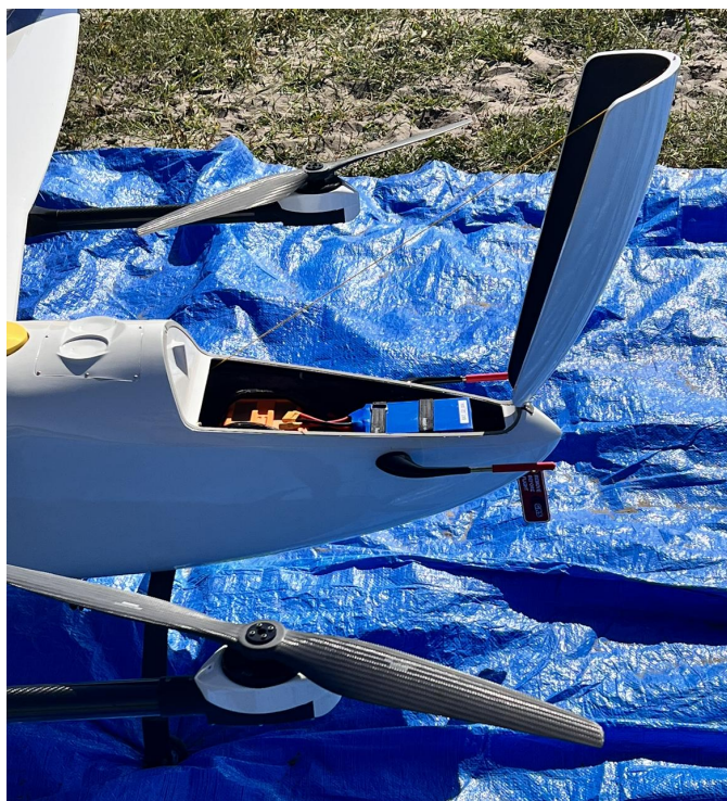
Rys. Zidentyfikowany obiekt latający (BSP zarejestrowany w aplikacji Stramed) na ziemi z zamontowanym nadajnikiem/odbiornikiem typu ADS-B
